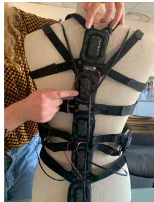
Figure 2. Version prototype du harnais multimodal. Il comporte neuf actionneurs (technologie Actronika) intégrés dans la structure : deux sur les clavicules, deux sur les côtes et cinq le long de la colonne vertébrale. Les attaches sont ajustables par velcro, parmi lesquelles deux passent autour des jambes pour assurer le maintien serré du dispositif sur le corps. La carte multicanale audio-haptique est connectée au harnais et se situe (pour l'instant) à la base de l'axe de la colonne vertébrale.
