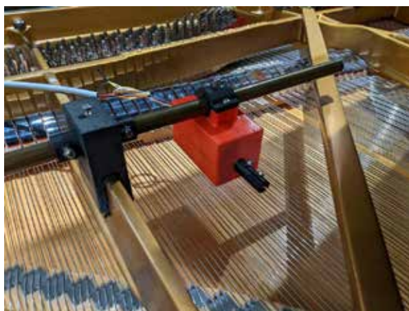
Figure 2. Piano préparé – Moteur et montures/boîtier en impression 3D.
