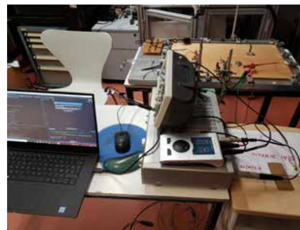
Figure 12. Banc de mesure pour corde vibrante.
