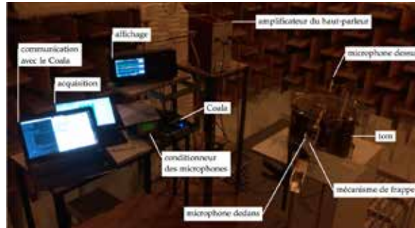
Figure 4. Dispositif expérimental complet installé en chambre anéchoïque.
