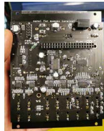
Figure 5. Cartes convertisseur ADC/DAC pour Jetson Nano – Soudure de composants CMS.
