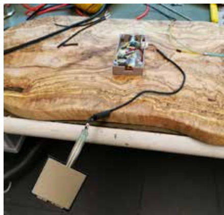
Figure 9. Contrôleur musical utilisant un module R-IoT, IMU + deux capteurs de pression.
