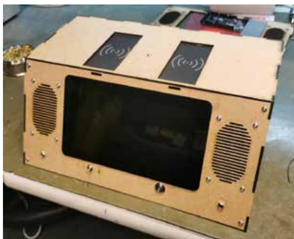
Figure 8. Pupitre de rééducation de patient AVC avec recharge par induction, haut-parleurs, écran tactile.
