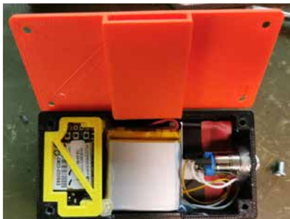
Figure 7. Module R-IoT intégré dans un boîtier sur mesure (impression 3D) avec recharge par induction
