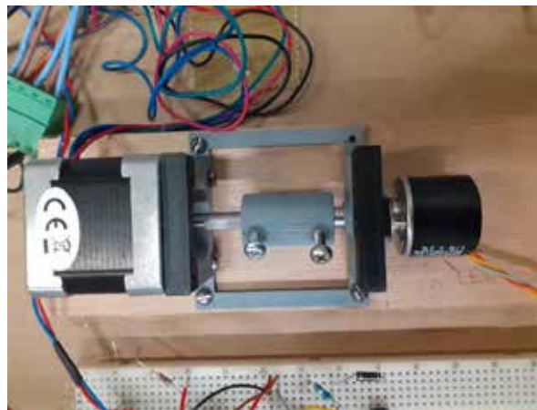
Figure 3. Automatisation de mesures – Moteur pas-à-pas et berceau en impression 3D.
